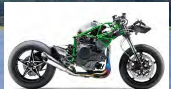
Ninja H2R: Gitterrohrrahmen und Kompressormotor
