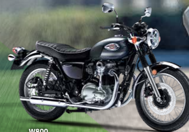
W800 Leistung 48 PS (35 kW), Leergewicht (fahrfertig) 226 kg, Sitzhöhe 790 mm
