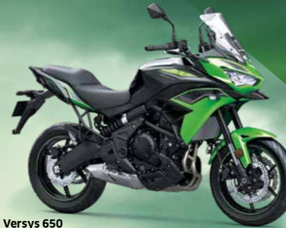
Versys 650 Leistung offen 67 PS (49 kW)*, Leergewicht (fahrfertig) 219 kg, Sitzhöhe 845 mm
