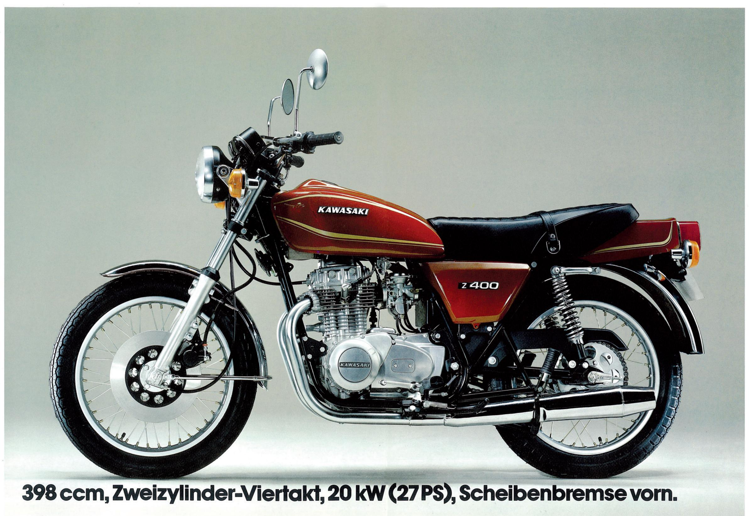
**398 ccm, Zweizylinder-Viertakt, 20 kW (27 PS), Scheibenbremse vorn.**
