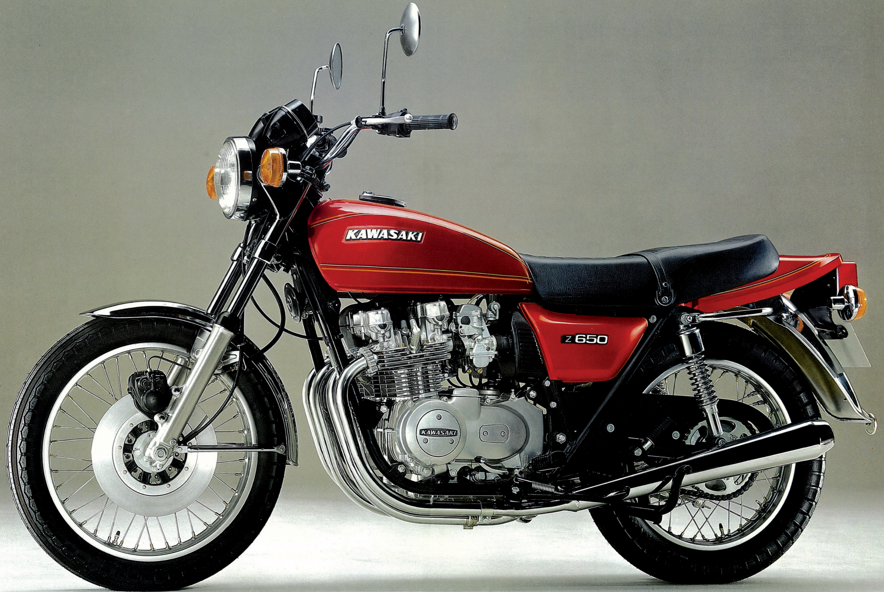
647 ccm, Vierzylinder-Viertakt, zwei obenliegende Nockenwellen, 66 PS, Scheibenbremse vorn.
