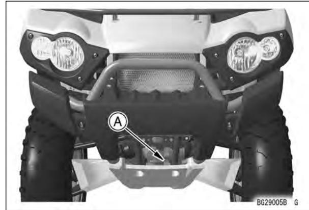
A. Einbauposition für Winde
