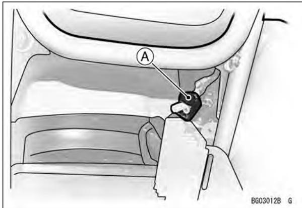
A. Steckverbinder für elektrische Zusatzverbraucher
