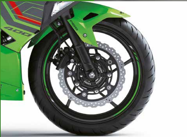
Kraftvoll: Scheibe mit Doppelkolbensattel vorne.
